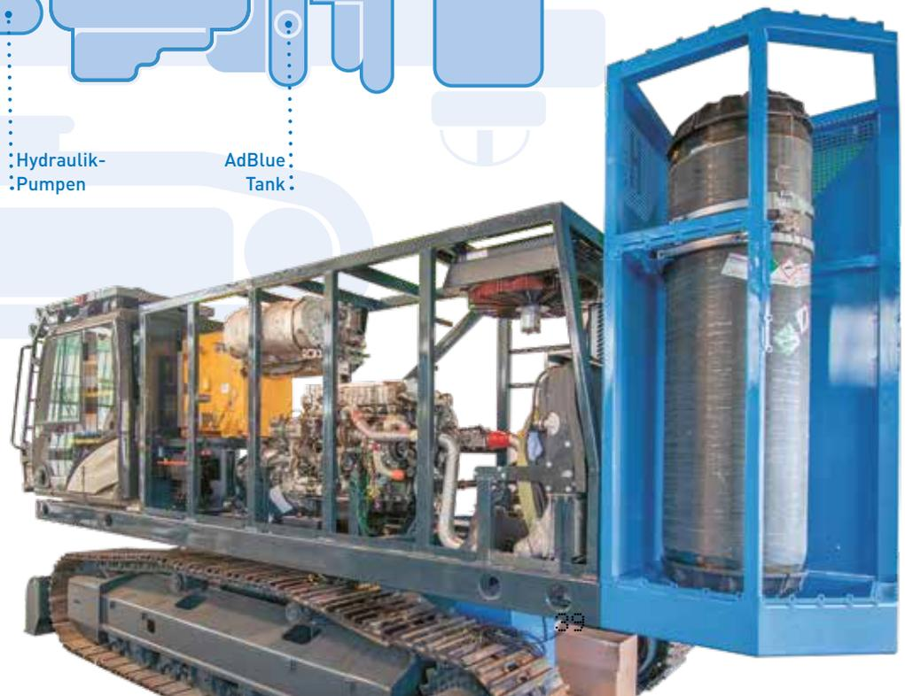
Speziell bei Baumaschinen für den Off-road-Bereich besteht die große Gefahr einer mechanischen Beschädigung eines Tanks. Deshalb musste hier vor dem Hintergrund des in WaVe entwickelten Sicherheitskonzeptes ein besonderer Aufwand zum Schutz des Tankmoduls betrieben werden.
